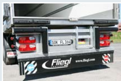
Der Unterfahrerschutz ist geschlossen und mit ausziehbarem Auftritt ausgestattet.
