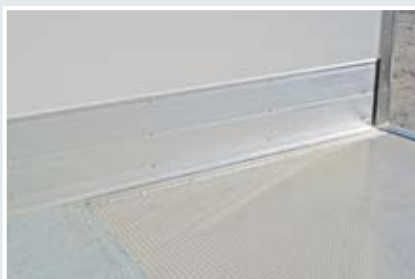
Kunststoffboden mit Aluminium-Gerstenkorblech und Aluminium-Scheuerleiste.
