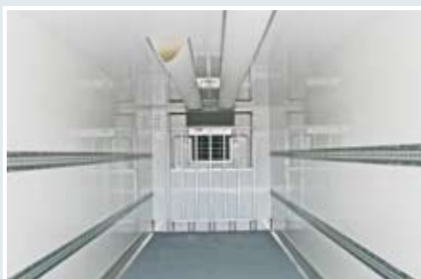
Verdampfungsschutzgitter und Kombizurrschienen. Weitere Ausstattungsvarianten auf Anfrage.
