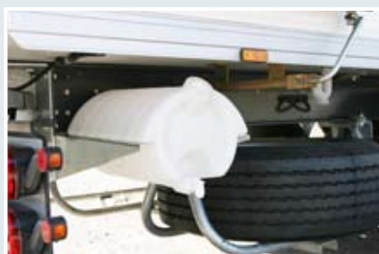
Wassertank und Reserveradhalter sind leicht zugänglich.
