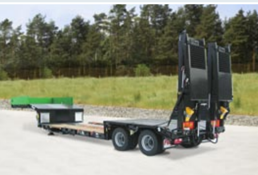
Низкорамный полуприцеп с отдельными рампами.
