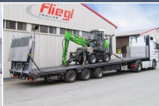
Наклоннорамный полуприцеп в различных исполнениях, например с насквозь идущей рампой.
