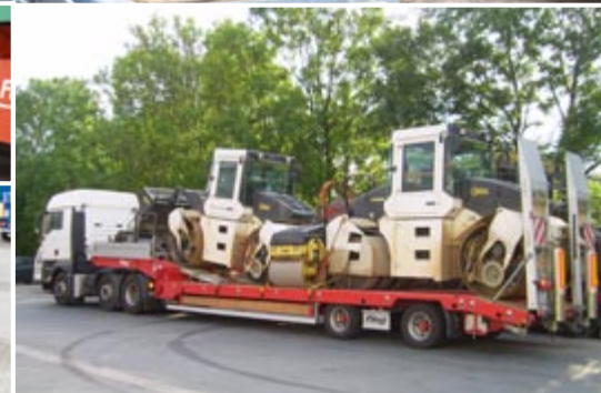
2-х осный полуприцеп с низкой 10 м площадкой.
