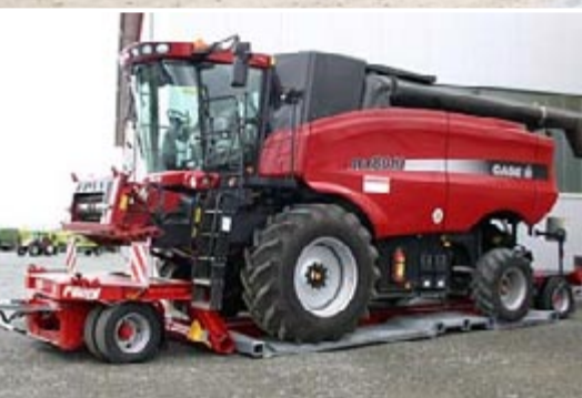
ЦТС 200 специал, для подстригающего транспорта с высотой погрузки 250 мм, снимаемой задней осью для почти одного земле уровня загрузки.
