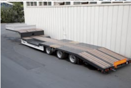
Усиленный юмбо – полуприцеп для грузового и с/х транспорта.
