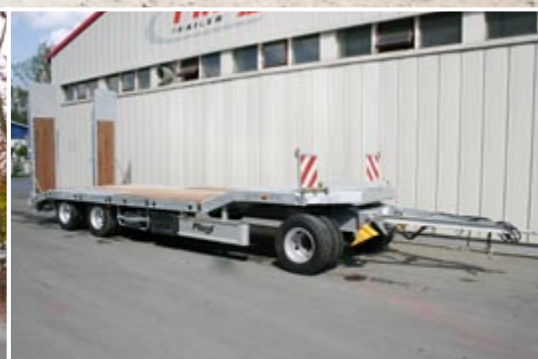
Низкорамник с наклонной загрузочной поверхностью. Все низкорамники от Флигл поставляются оцинкованные огнём, для лучшей защиты от коррозии.
