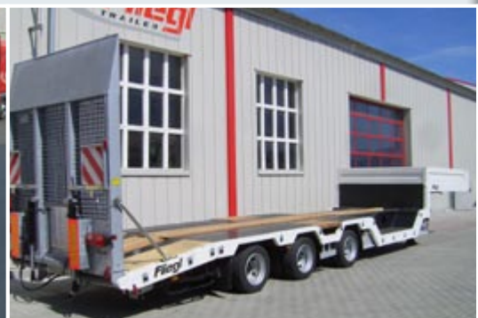
Низкорамный полуприцеп с двумя колёсными выемками.
