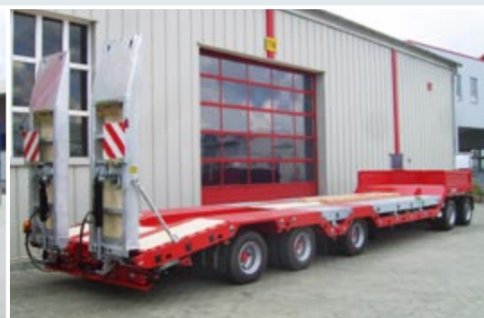
5-осный низкорамный прицеп с колёсными выемками и поворотной осью.
