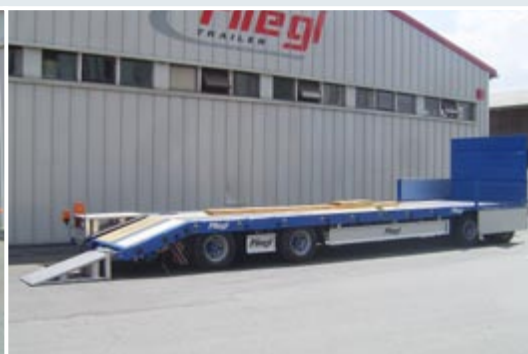
4-х осный низкорамный прицеп с прямой платформой и алюминиевыми откидывающимися рампами на корме.
