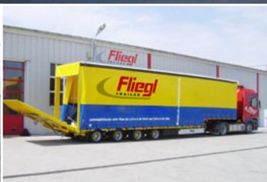
4-х осный тентованный полуприцеп с 3,5 м внутренней высотой и расширяемый на 4 метра.
