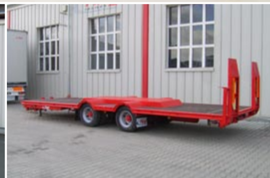
Тандем низкорамный прицеп специально сконструирован для транспортировки с/х машин.
