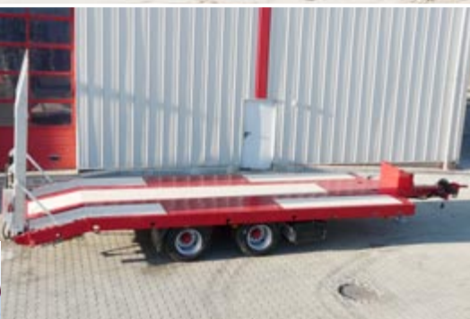
Низкорамный прицеп для строительного транспорта, с вальцевым удлинением спереди.
