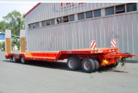
Низкорамный прицеп с большими выемками для колёс.
