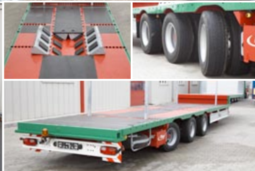
Юмбо койлполуприцеп в усиленном исполнении со стоечными карманами и поворотной осью.
