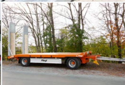
2-х осный низкорамный прицеп в коротком исполнении.
