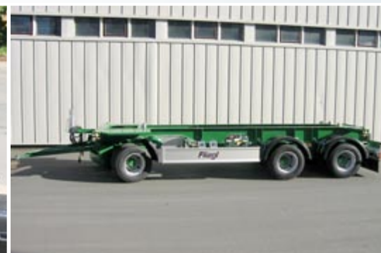
Трёхосевой с вращаемой осью сменный прицеп поставляем в различных вариантах. Мы поставляем большое число дальнейших вариантов по запросам.
